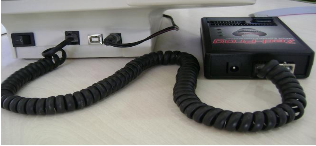
Şekil 2.1 Zed-Prog & Zed-Bull Bağlantısı
